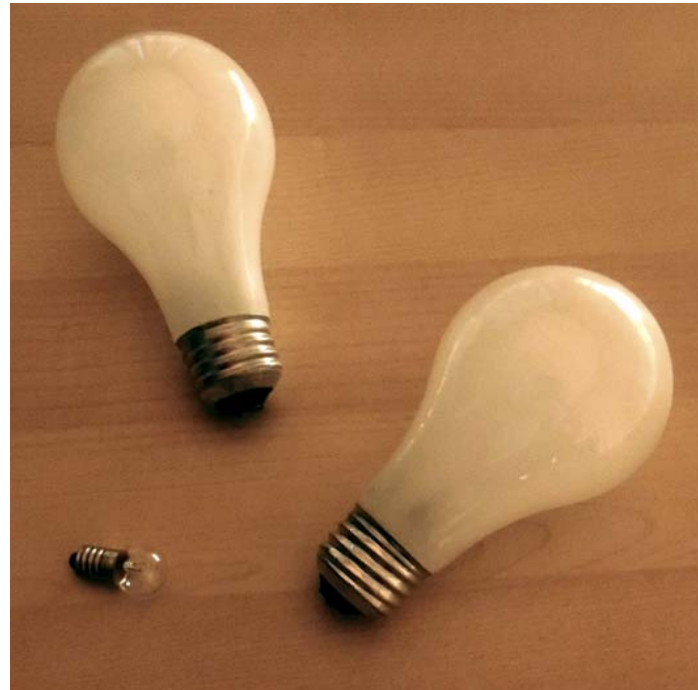
FIGURE 1.46 AMPOULE MINIATURE (100 W / 120 V) ET AMPOULES DOMESTIQUES (100W ET 40 W)
