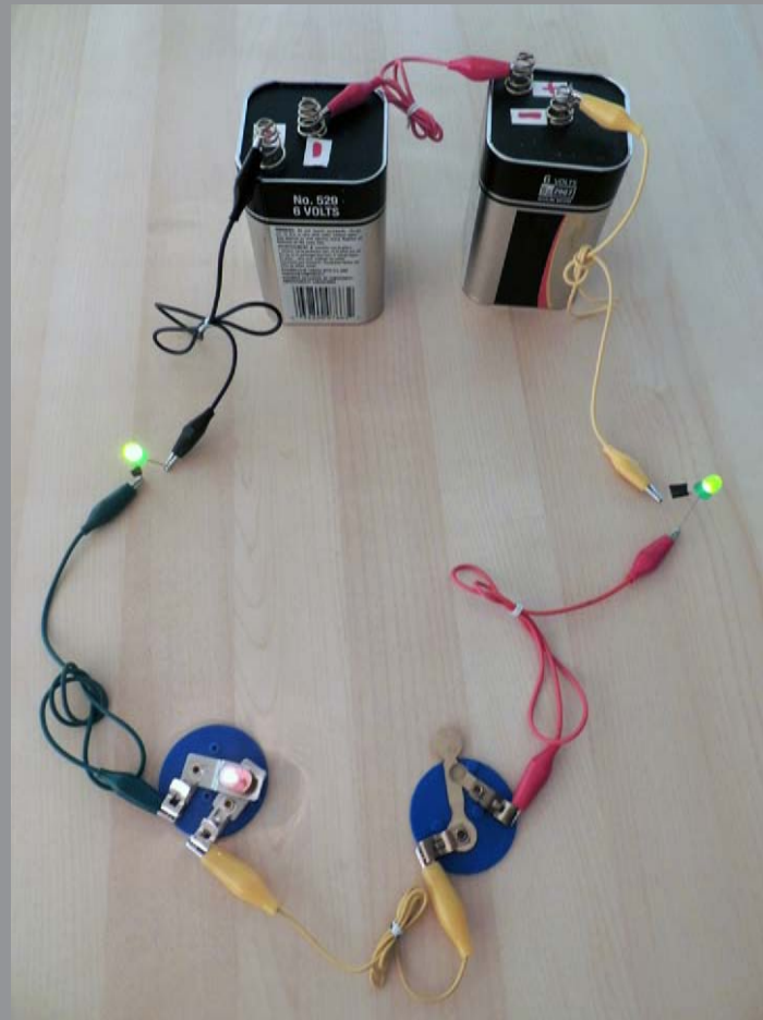
FIGURE 1.36 INTERRUPTEUR FERMÉ ET L'AMPOULE ET LES DEUX DIODES ALLUMÉS
