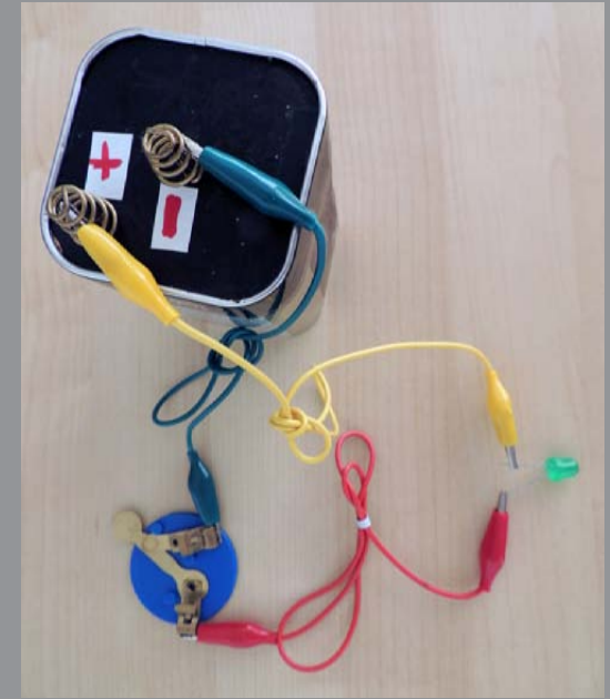
FIGURE 1.32 FILS INTERCHANGÉS ET DIODE ÉTEINTE
