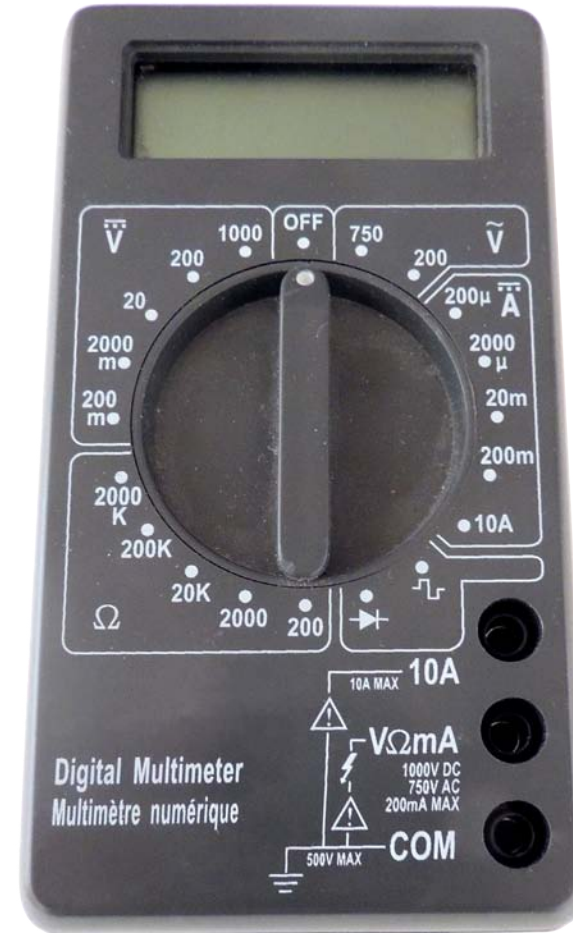
FIGURE 1.38 MULTIMÈTRE À TROIS PRISES
