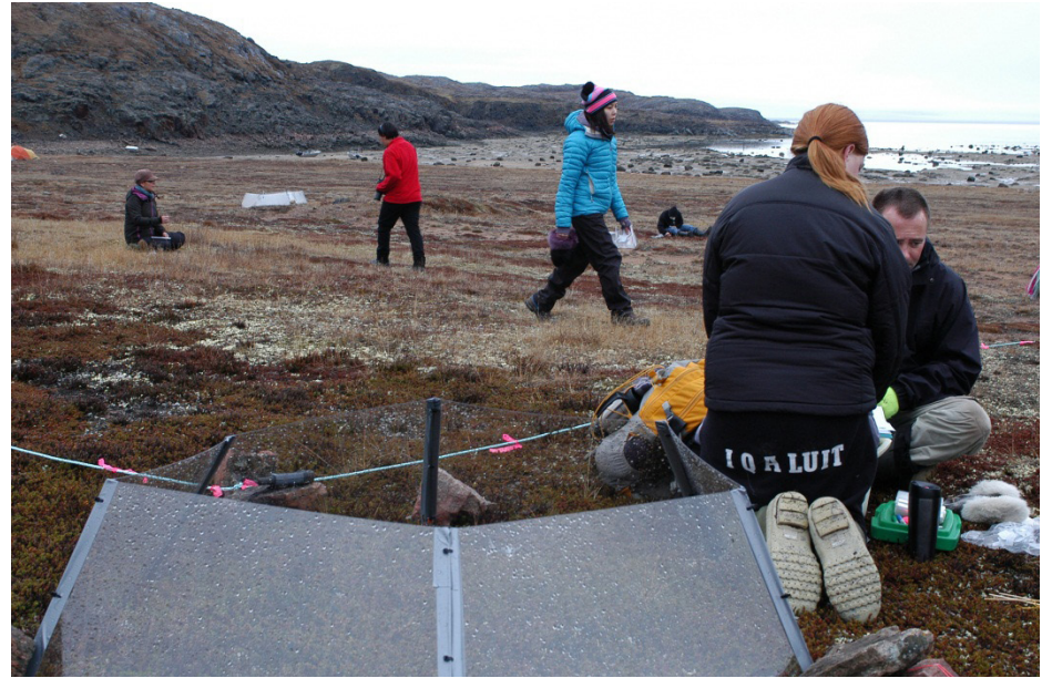
FIGURE 3.28 UN MODÈLE DE SERRE POUR LES RECHERCHES DANS LE GRAND NORD
