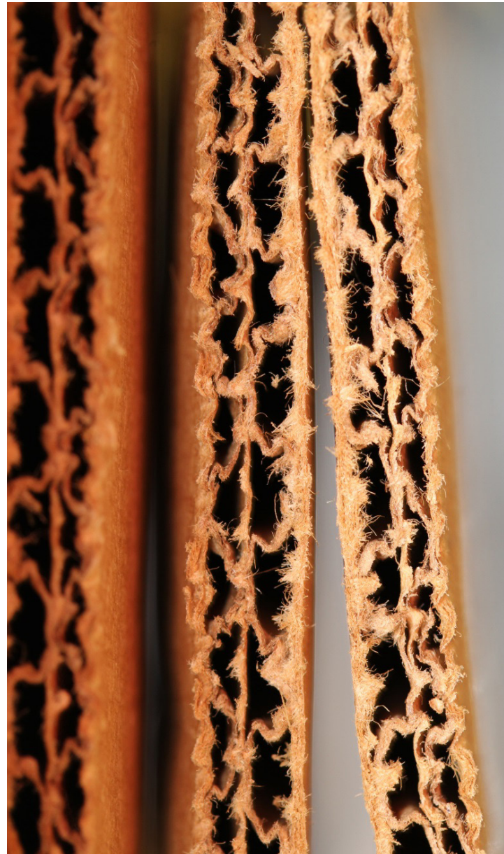
FIGURE 5.24 UN CARTON ONDULÉ... POUR UN MAXIMUM DE RÉSISTANCE
