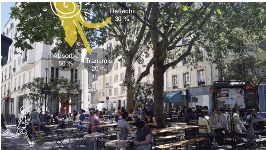
Figure 6.1. L'arbre urbain est un outil efficace contre les îlots de chaleur urbains en absorbant et en réfléchissant une partie de l'énergie solaire reçue (d'après une photographie de Serge Muller).
